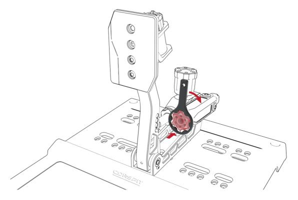
Install the preload knob. 装回预紧旋钮。
