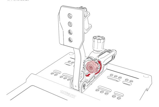
Use the tool to remove the elastomer cylinder nut. 使用工具取下胶缸螺母。
