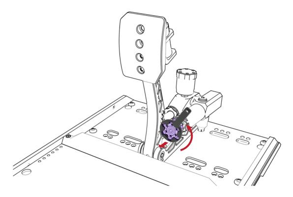
Remove the elastomer cylinder nut. 取下胶缸螺母。
