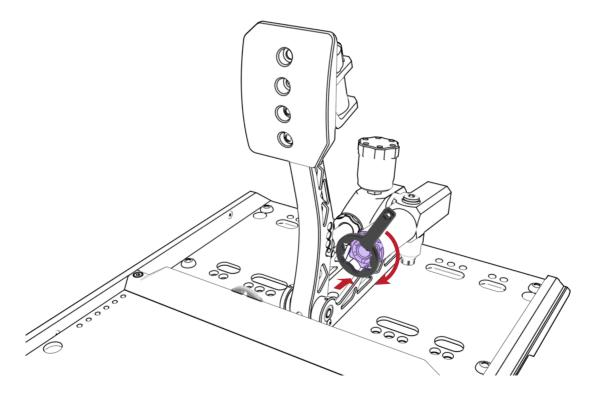
Install the front preload knob. 装回前部预紧旋钮。
