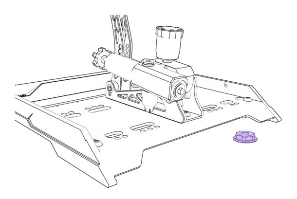
Remove the front preload knob. 取下前部预紧旋钮。
