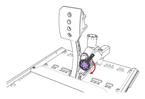
Install the rear preload knob. 装回后部预紧旋钮。
