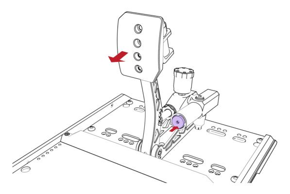
Install the lastomer cylinder nut using tools. 使用工具装回胶缸螺母。
